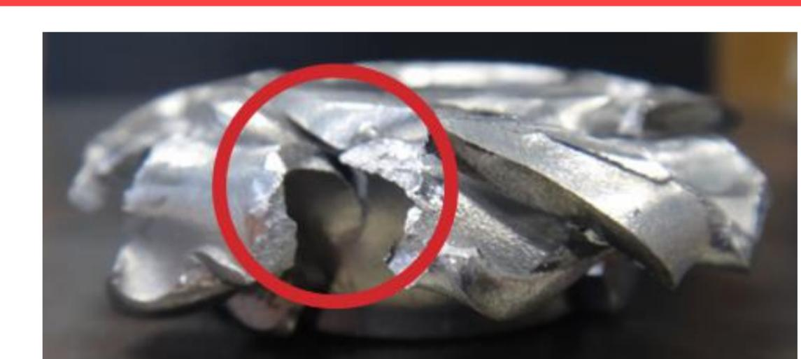
亀裂が発生すると、モデルを座屈させるために必要な力が小さくなり、モデルが吸収できるエネルギー量も小さくなつた。
