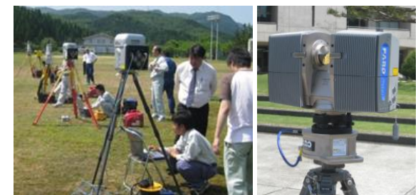
産学連携による地上型レーザの精度比較の実証実験
