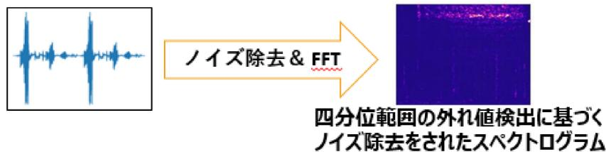
AEを用いてノイズ除去を行い、Encoder部分からノイズ除去された特徴マップを抽出
