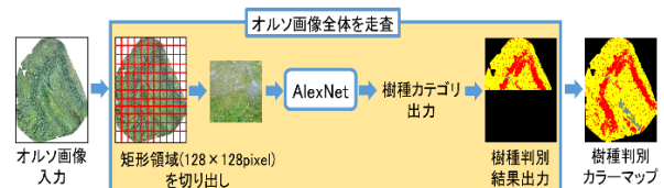
図 2 「樹種判別」の処理の流れ Fig. 2 Processing flow of the tree species discrimination.
