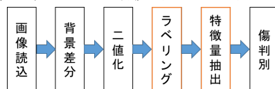
図2. 特微量による傷検出手法
