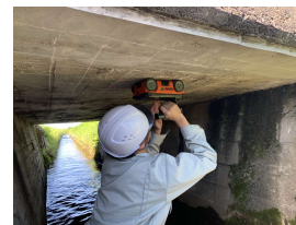
鉄筋かぶり：20mm程度
