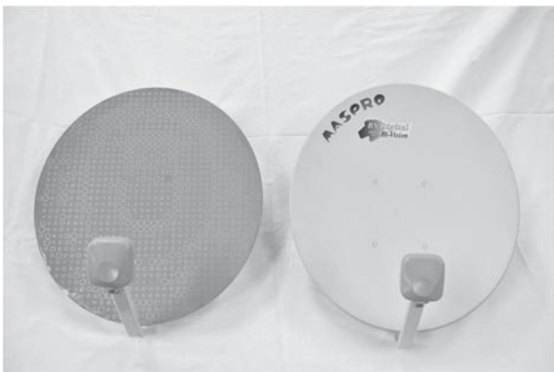
図 12 パラボラアンテナと試作したリフレクタレーアンテナ Fig. 12 Manufactured reflectarray and parabola antenna of marketing product.
