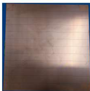
図 14 製作した AMC 基板 Fig. 14 The fabricated AMC substrate.
