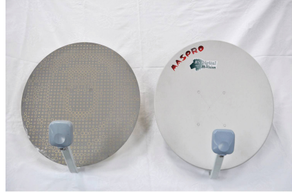
図 16 パラボラアンテナと試作したりフレクトアレーアンテナ
