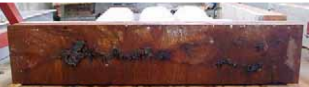
写真-3 外観状況 D13全No.2 (120A・day)
