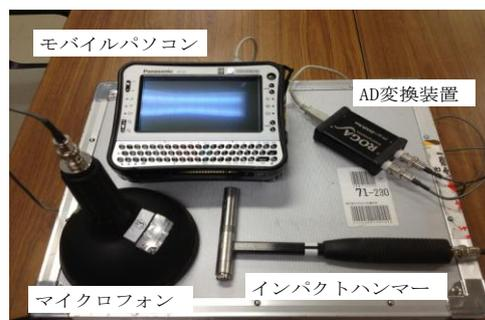
写真-2 打音法の計測システム
