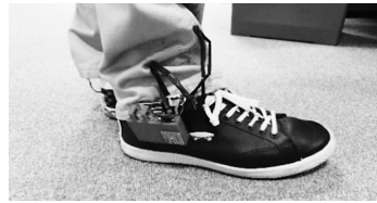
図4 インソール型歩容センサー（プロトタイプ）の装着時
