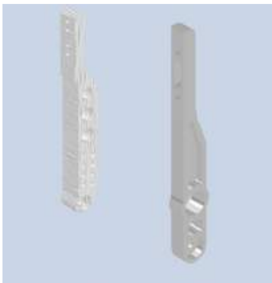
図 2.3.3.7 ブレーキペダル (左 : 19model 右 : 20model)
