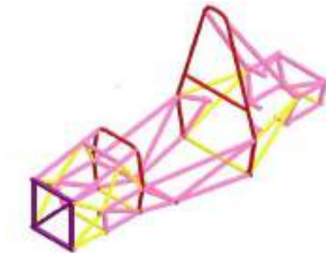
図 2.3.1.1 21model フレーム形状
