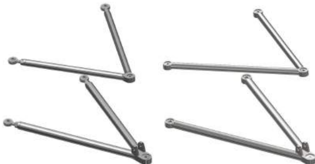
図 2.3.2.8 フロントアームの比較（左：19model 右：21model）
