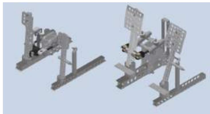
図 2.3.3.3 ペダルユニット（右：19model、左：20model）
