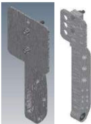
図 2.3.3.6.7 18model と 19model のブレーキペダル
