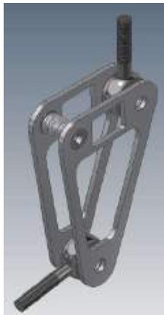
図 2.3.3.7.5 19model のベルクランク
