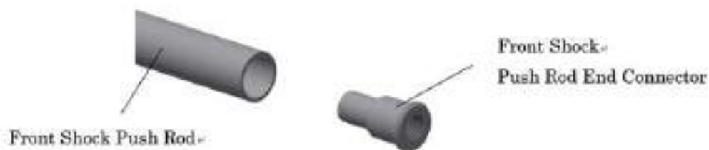
図 2.3.2.3 フロントショックプッシュロッドの構造
