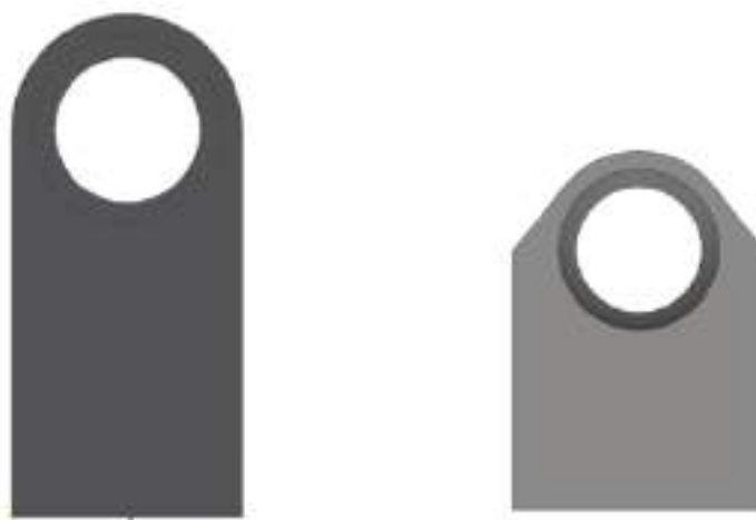
図 2.3.2.19 コーナーブラケット形状比較[リア](左 : 17model、右 : 18model)
