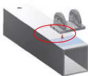
図 2.3.3.17 ペダルユニットの溶接用の溝
