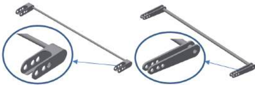
図 2.3.2.2 スタビライザー比較(左：17model、右：18model)
