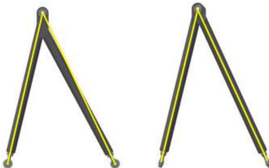
図 2.3.2.18 アーム形状比較(左 : 17model、右 : 18model)
