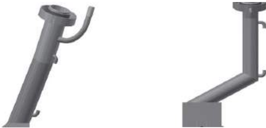
図 2.3.3.10 フィラーネックの形状変更(左 : 17model、右 : 18model)
