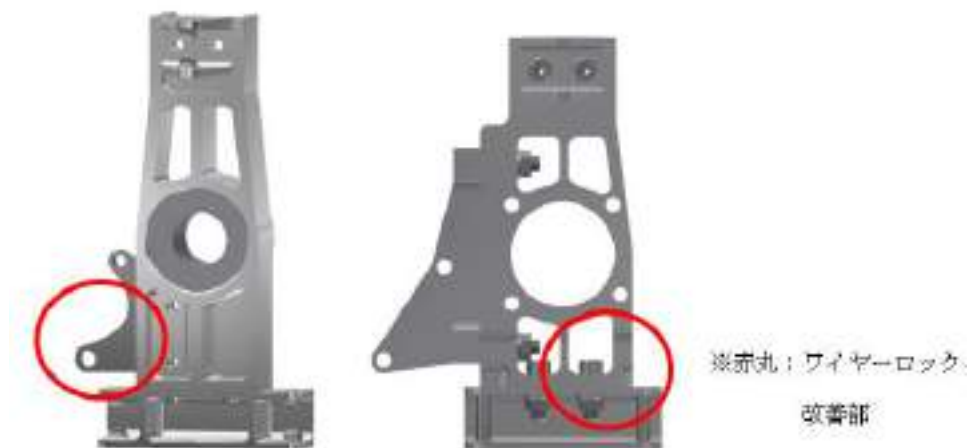
図 2.3.2.11 リアアップライトモデル比較(左 : 17model、右 : 18model)
