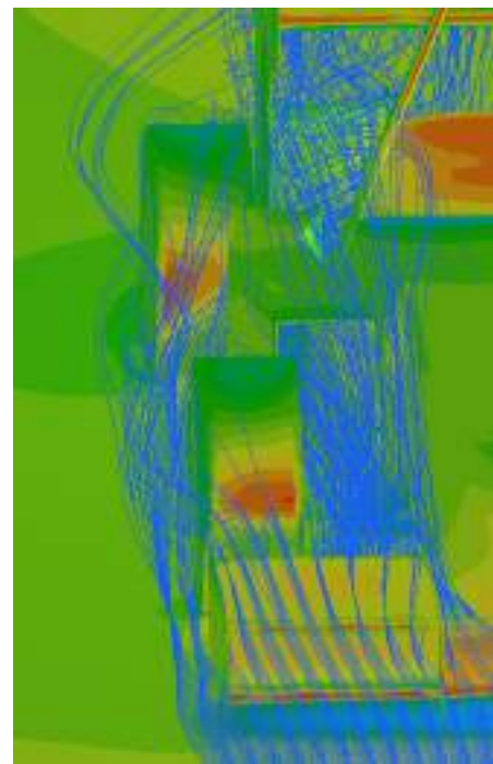
図 2.3.4.9 右サイドポンツーンへの流れ
