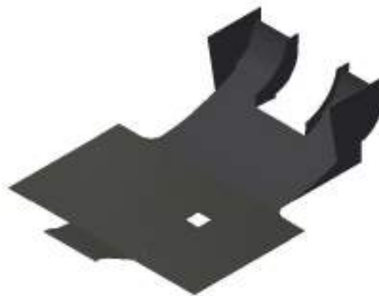
図 2.3.4.10 アンダーパネルとディフューザーのモデル
