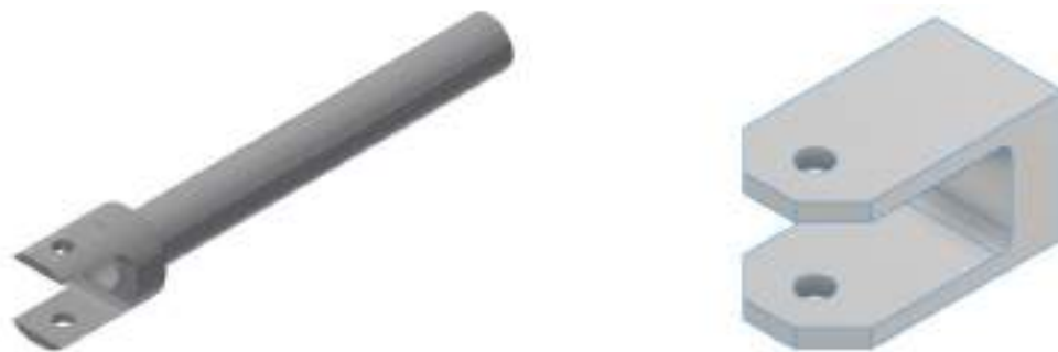
図 2.3.2.4 Rack(左 : 16model)と Rack End(右 : 17model)
