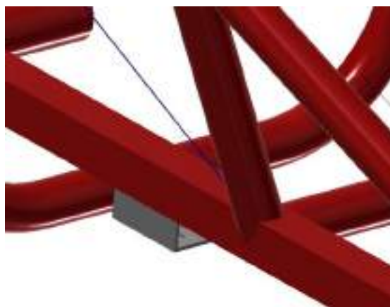
図 2.3.2.2 スタビライザーステーブラケット(16model)
