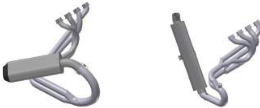
図 2.3.3.2 パーツの形状比較(左 : 16model, 右 : 17model)
