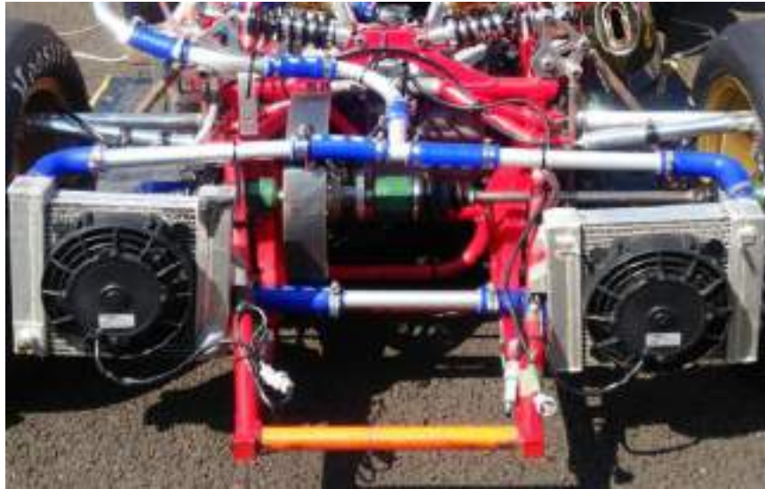
図 2.12 走行試験時のラジエーター
