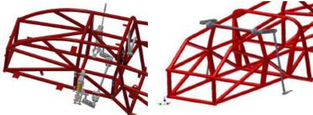
図 2.7 スタビライザーのレイアウト比較(左：15model 右：16model)
