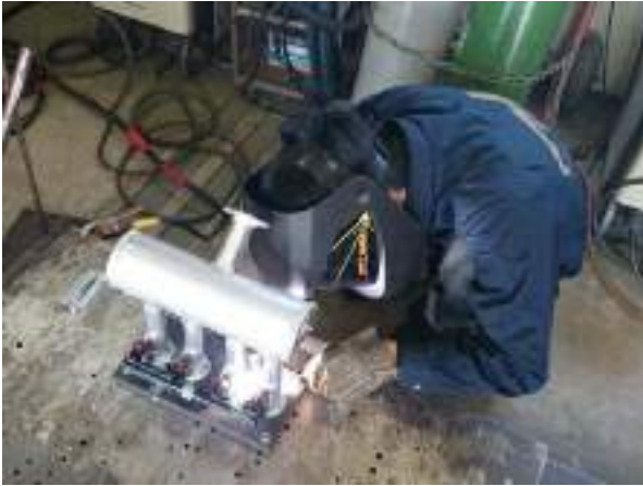
図 3.5 春休み製作期間(吸気管の溶接)
