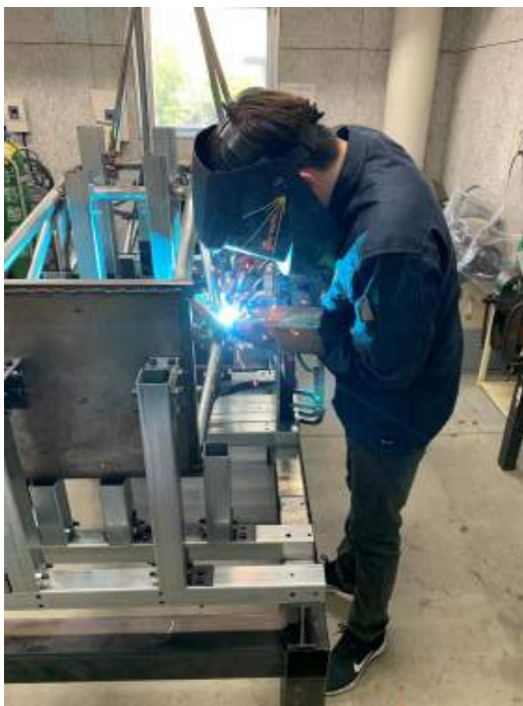
図2 アームステイ溶接の様子
