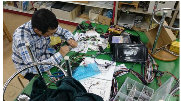
図 4 MoTeC用の配線製作
