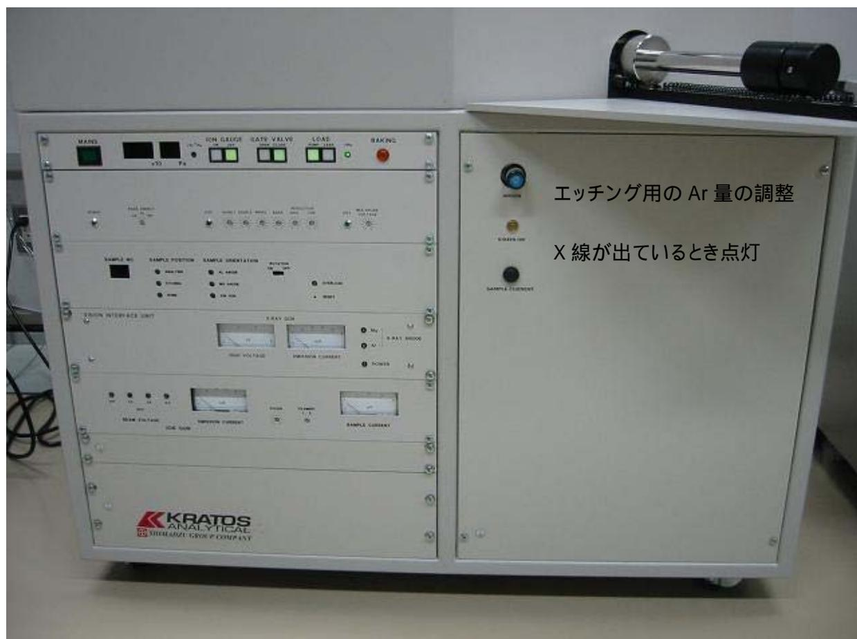
本体前面パネル ( MAIN スイッチ、ION GAUGE を OFF にしたところ )
