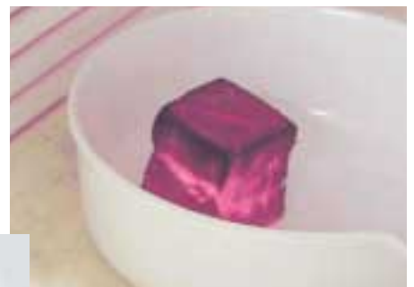
ファイアレスBに浸けておいた木片を750°Cで加熱
